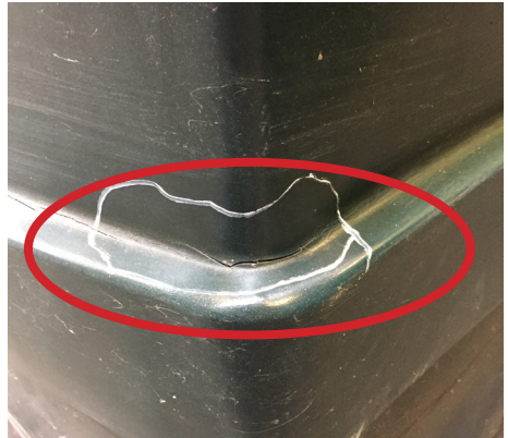
Revne opstået i indadgående hulning
